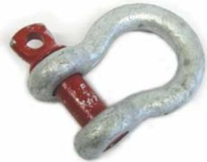
La giunzione tra la rete SPIDER® e le funi è ottenuta con grilli. Essi garantiscono che la rete può scorrere sulle funi di supporto senza danneggiarla. Le reti sono connesse anche verticalmente con grilli. In generale, i grilli hanno la funzione di garantire continuità di funzionamento alla soluzione tecnica. I grilli possono essere fissati con colla adesiva (p.e. LOCTITE) se è necessario per essere a prova di furto.
