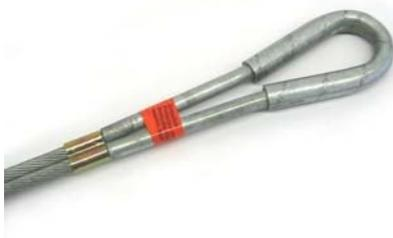
Le funi di supporto e i controventi si ancorano sia al terreno che alla roccia mediante l'ancoraggio in fune spiroidale Geobrugg. Gli ancoraggi in fune spiroidale sono dotati di una testa flessibile che assicura che possano essere trasmesse le forze che non lavorano direttamente nella direzione di trazione. Due tubi zincati sopra la testa di ancoraggio, più fune spiroidale zincata, forniscono una doppia protezione contro la corrosione.
