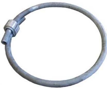
La funzione degli elementi dissipatori Geobrugg (asole frenanti) è di assorbire energia con deformazioni plastiche e per attrito e di proteggere le funi da eventuali sovraccarichi. Essi sono costruiti sulle funi di supporto in posizione laterale in modo tale da permettere una facile sostituzione. Il tubo in acciaio protegge la fune dalla corrosione e da danni di carattere meccanico.
