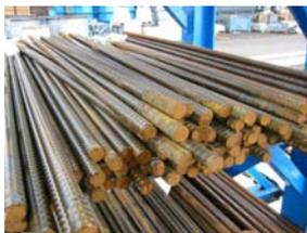
Chiodi per terreni  $\phi$  16 mm, l = 600 mm sono usati per ancorare la rete SPIDER® e quella secondaria al terreno.
