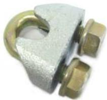
Le funi vengono consegnate con le asole pressate ovunque possibile. Dopo il tensionamento, le estremità libere devono essere fissate con morsetti in accordo alla EN 13411-5 (DIN 1142). E' molto importante usare il giusto numero di morsetti adottando una coppia di serraggio corretta. I morsetti possono essere fissati con colla adesiva (p.e. LOCTITE) se è necessario per essere a prova di furto.
