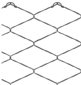
Lo SPIDER® S4 130 è l'elemento principale del sistema ed è costituito da funi con diametro di 8.6 mm formate da tre fili di 4.0 mm di diametro ognuno, formando una maglia a rombo con un diametro interno di 130 mm. La rete SPIDER® è anche ancorata al suolo con chiodi e legata alle funi di supporto con grilli.
