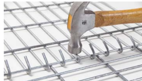
In order to speed up the following closing operation, you can use a hammer. Um die Haken schneller zu schließen, können Sie einen Hammer benutzen.
