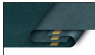
Applicare pressione per fissare le due file. È possibile far scorrere una tavola di legno di almeno 30 cm di larghezza sotto la tenuta, in modo da utilizzarla come superficie di supporto. Spostare la tavola durante la realizzazione della giunzione. Questo sistema senza graffe può essere utilizzato in presenza di un suolo molto roccioso.
