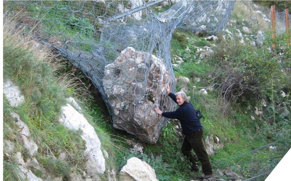
Particolare di una barriera sottoposta a carico statico della neve
