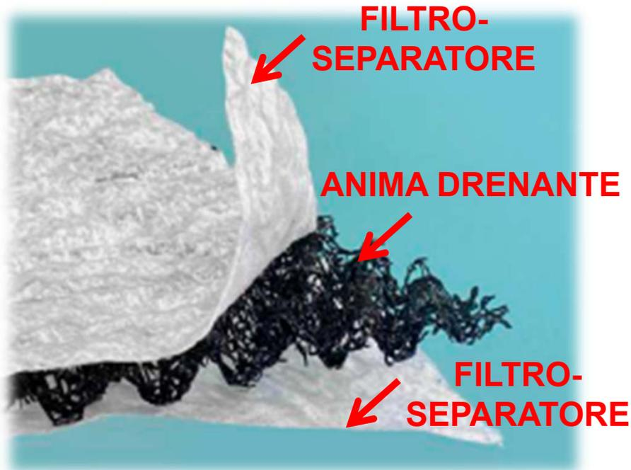
Oggi esistono dei sistemi drenanti di nuova concezione, detti **GEOCOMPOSITI DRENANTI**, studiati per ottimizzare i processi di emungimento nei terreni e in grado di rendere l'intervento non solo efficace, ma anche efficiente dal punto di vista dei tempi di realizzazione ( **minori volumi di sbancamento, assenza di materiale naturale drenante, reimpiego del materiale sbancato, posa manuale del geocomposito drenante** ) .
