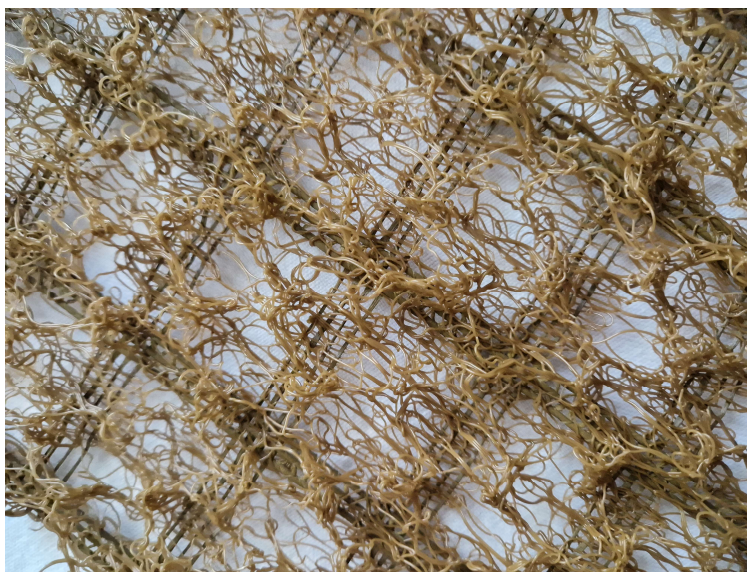
lato grimpante 3D in filamenti aggrovigliati di PP
